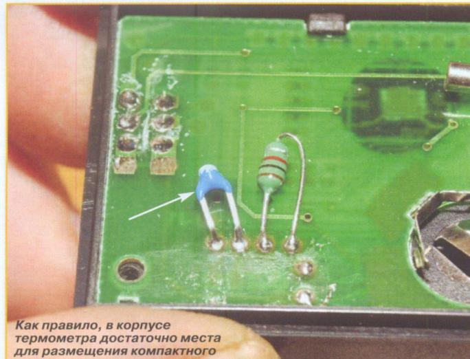
Как правило, в корпусе термометра достаточно места для размещения компактного дополнительного резистора. Стрелкой отмечен термистор.
