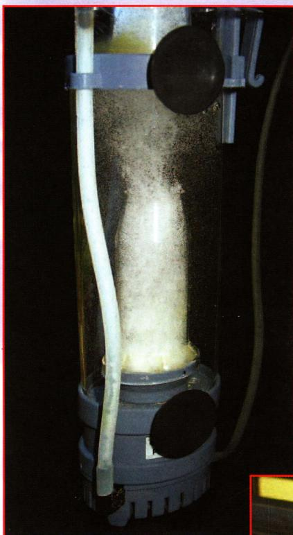
тром с губками для механической очистки и высокопористой керамикой **SERA siporax®**, обеспечивающей высокоэффективную биофильтрацию. Кроме того, в камерах фильтра располагаются входящие в комплект поставки пеноотдели-
